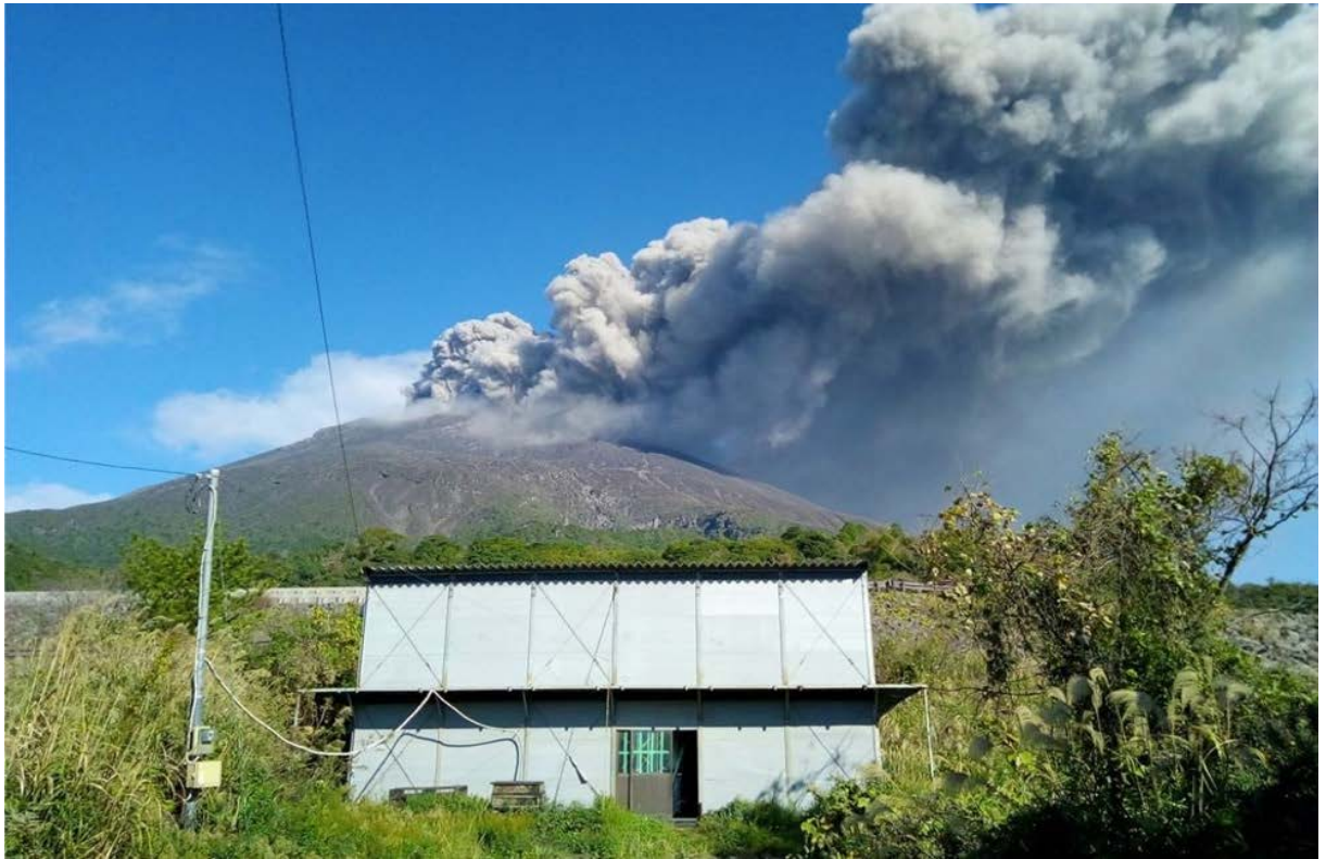
図 2 並列高解像度火山透過システムのハウジングと桜島。5 式の並列高解像度火山透過システムは全て桜島方向へ向けられた。
